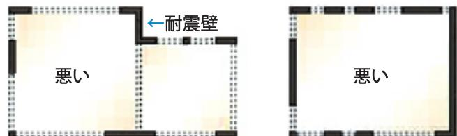
新築の場合は現在の法律で決められた強い壁が配置されますが、昔の住まいはその強い壁の量が少なかつたりバランスが悪かつたりしますので、耐震診断をして補強されることをお奨めします。
